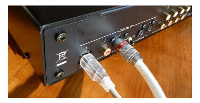
Au chapitre des entrées numériques, notons la présence d'une USB type B, et de quatre S/PDIF (deux coaxiales et deux optiques) dont l'une est commutable au moyen d'un petit sélecteur mécanique.
